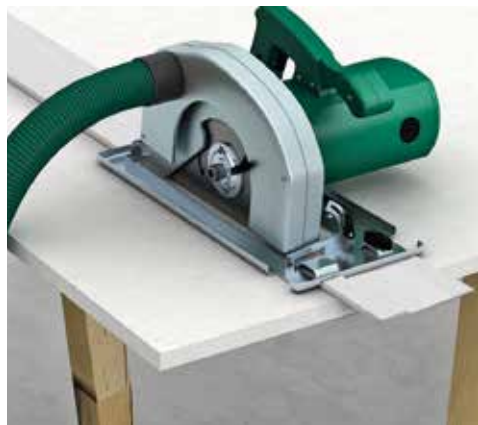
Sågning med sänksåg
